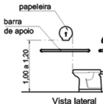
Figura 18 - Imagem referência instalação dispenser
