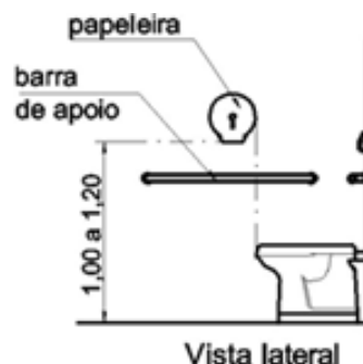
Figura 23 - Imagem referência instalação dispenser
