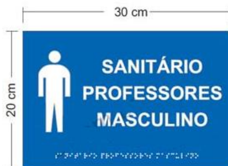
Figura 27 - Imagem de referência placa de sinalização dotada de letras em Braille dotada de pictograma
