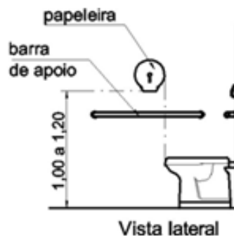
Figura 23 - Imagem referência instalação dispenser
